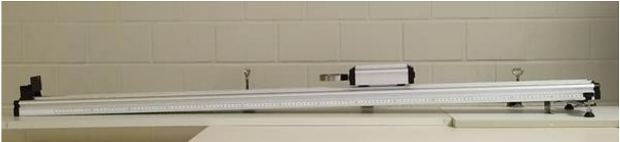
Abb.1 Die Grundidee des Versuchs bezieht sich auf die Untersuchung der Bewegung eines Fahrbahnwagens auf einer geneigten Rollenfahrbahn;
