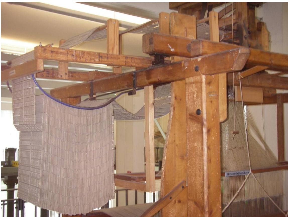
Bild 2: Jacquard Maschine: linke Seite "Lochkarten", rechts Fäden
