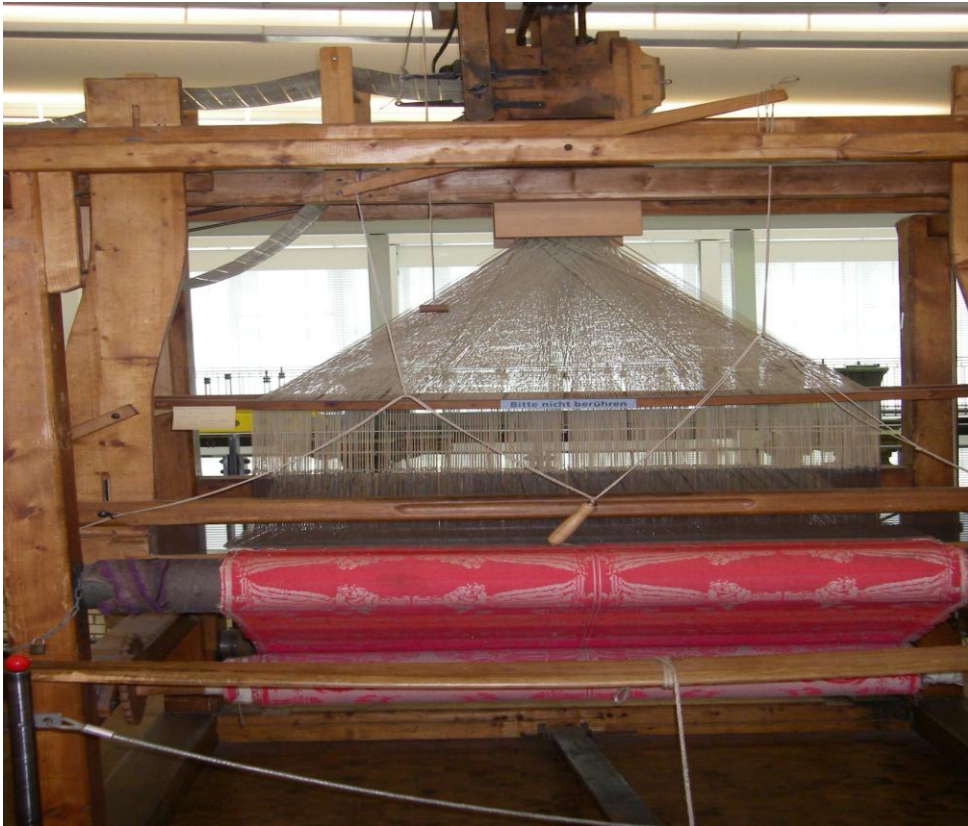
Bild 3: Fabrikation verschiedener und komplexer Muster: Jacquard-Webstuhl – die wahre Innovation
